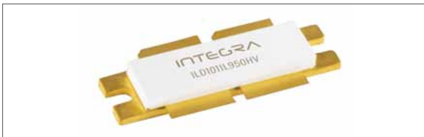
▲ Рис. 2. ILD1011L950HV — кремниевый LDMOS-транзистор с импульсной выходной мощностью 1100 Вт на частоте 1030 МГц при усилении импульсного сигнала в режиме Mode-S ELM в системах вторичной радиолокации
