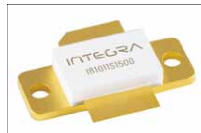
▲ Рис. 1. Импульсная выходная мощность кремниевого биполярного транзистора IB1011S1500 составляет 1400 Вт при усилении импульсного сигнала с длительностью импульса 10 мкс и коэффициентом заполнения 1%. Рабочая частота: 1030 или 1090 МГц
