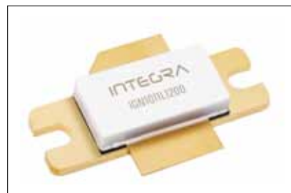
▲ Рис. 3. IGN1011L1200 — мощный GaN-on-SiC транзистор с импульсной выходной мощностью 1250 Вт. Транзистор предназначен для работы на частотах 1030 и 1090 МГц в режиме Mode-S ELM в составе систем вторичной радиолокации
