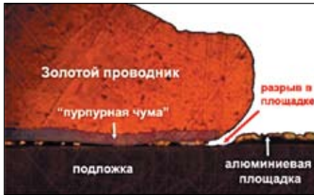
Рис. 9. Появление «пурпурной чумы» в месте контакта золота и алюминия
